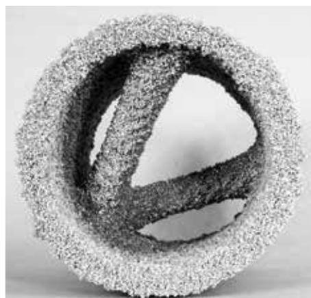
**ganz links:** Zelluläres Bauelement aus Leichtbeton, hergestellt durch selektives Binden (Cement Activation).
