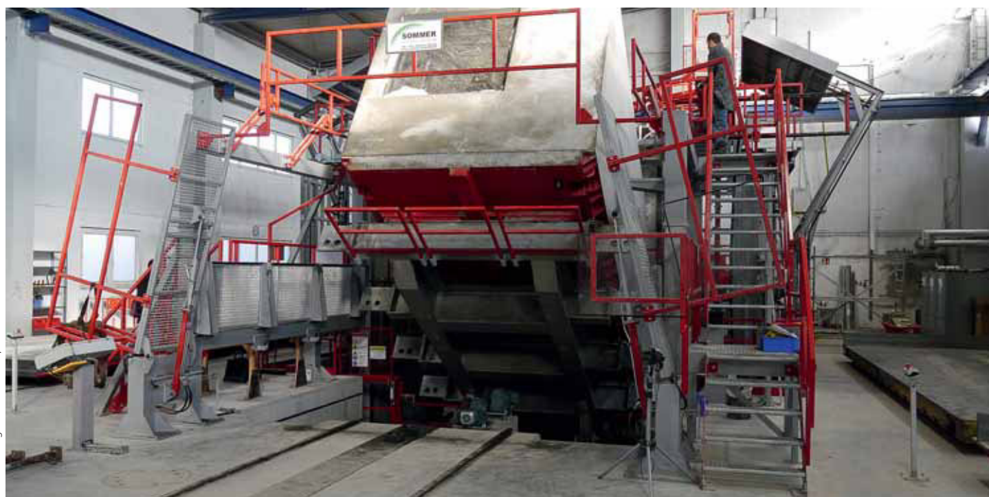
Eine Betonraumzelle wird aus der Kippkollenschalung der Firma Sommer Precast Technology gefahren.
